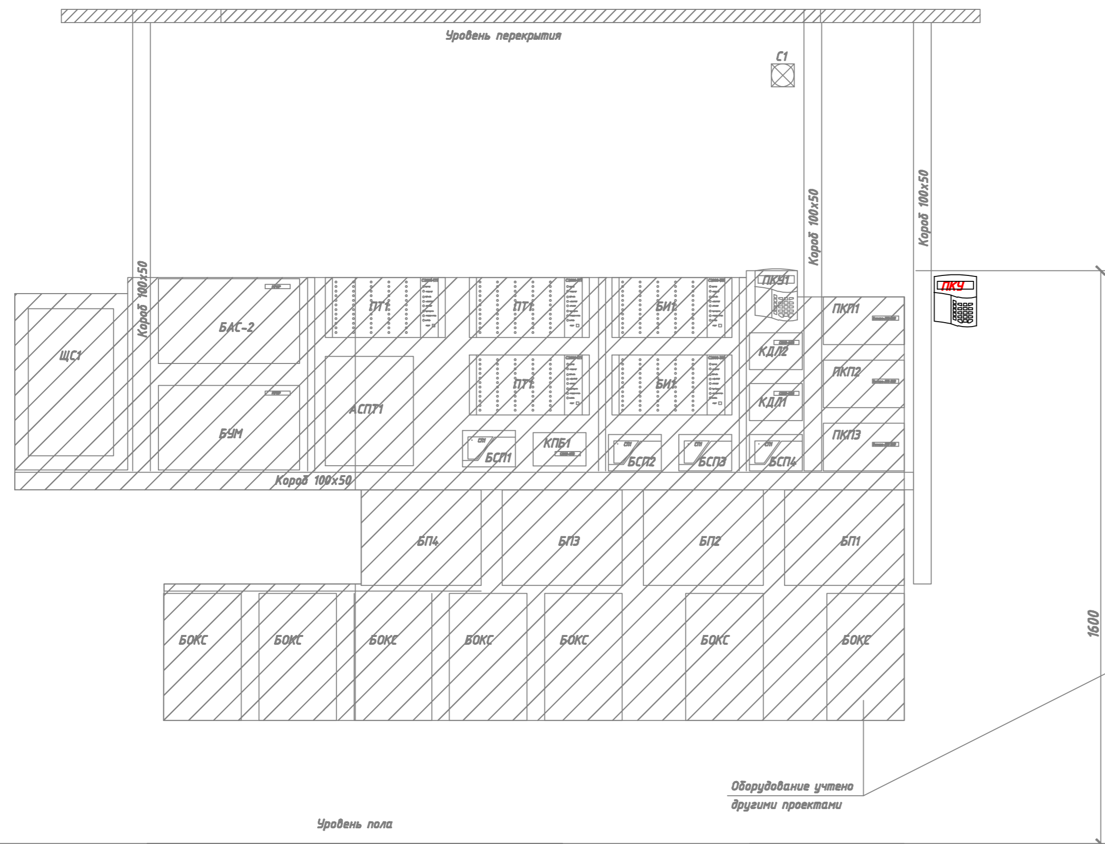
Вид-А План расположения оборудования на посту охраны
